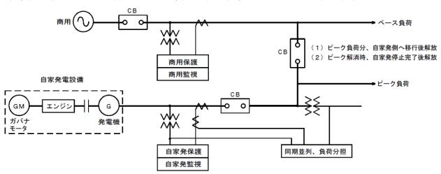
(3) 単独運転方式・・・有瞬断切換えにより自家発単独で運転する方式
