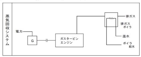
(3) 温水+蒸気回収・・・ 冷却水や排気ガスから温水および蒸気を回収する方式
