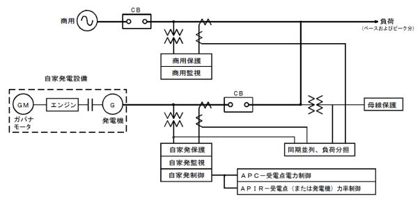
(2) 商用電源との一時連係方式・・・商用電源と切換え時一時並列運転を行う方式
