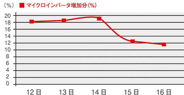
一般的なパワーコンディショナに対するマイクロインバータの発電量増加分
